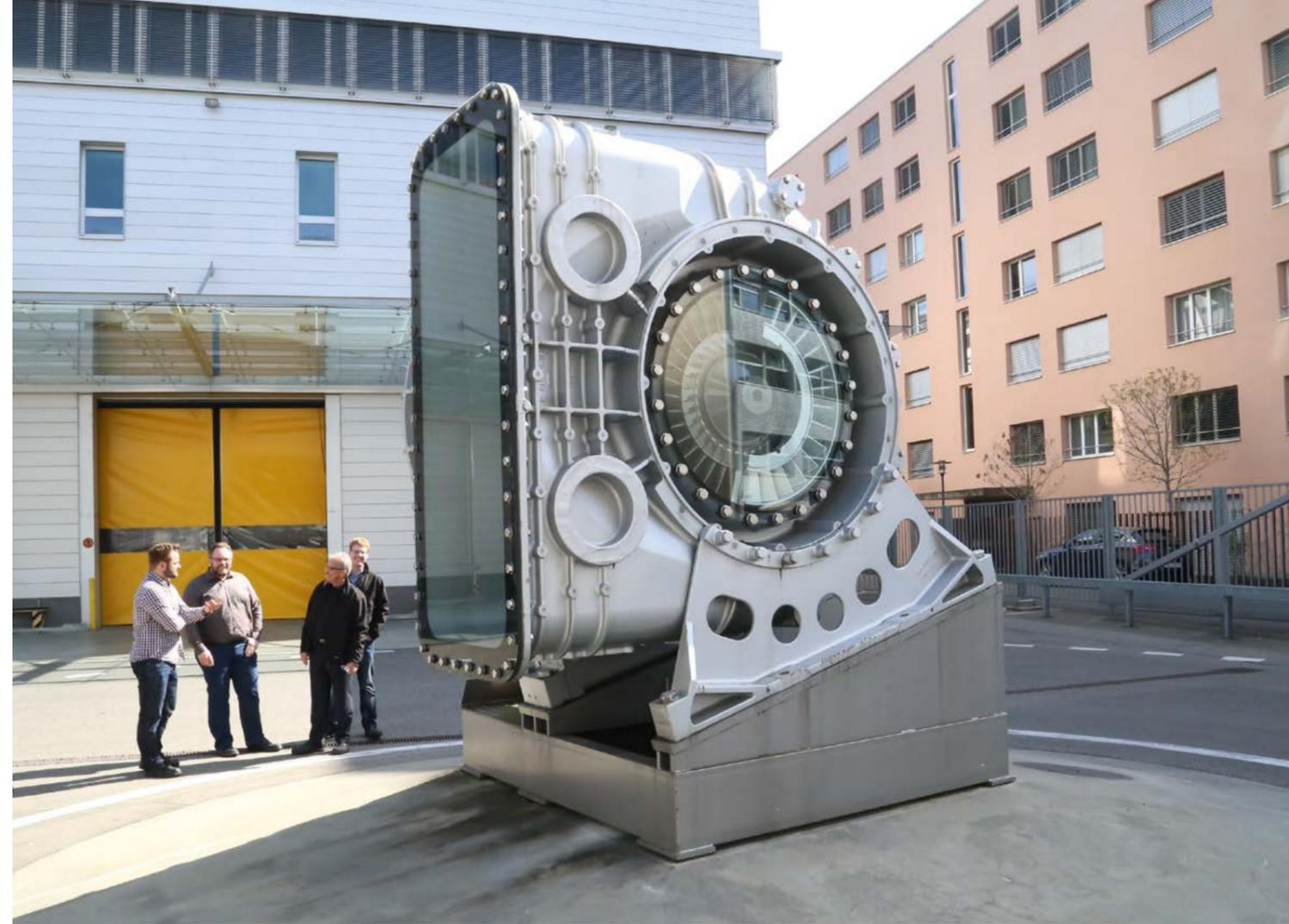
Gewaltige Dimensionen: Die ABB-Turbolader werden in Schiffsmotoren eingesetzt. Sie steigern deren Leistung bis zum Vierfachen. Aber letztlich ist die Prozesssicherheit entscheidend.
