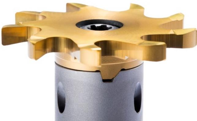
**Als Erweiterung des Programms mit drei- und sechsschneidigen Fräsplatten der Typen 332 und 632 entwickelte HORN eine noch leistungsstärkere Fräsplatte Typ 932 mit neun Schneiden und um 50 Prozent gesteigerter Zerspanungsleistung.**
