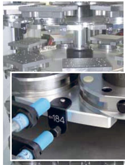
Das **EWIS™ Rapid** Identifikationssystem verschafft den Überblick über Halter und Paletten. Mit den modernen Transponder-Chips ist jede Palette jederzeit identifizierbar. Die Handlinggeräte prüfen den Magazininhalt automatisch.
