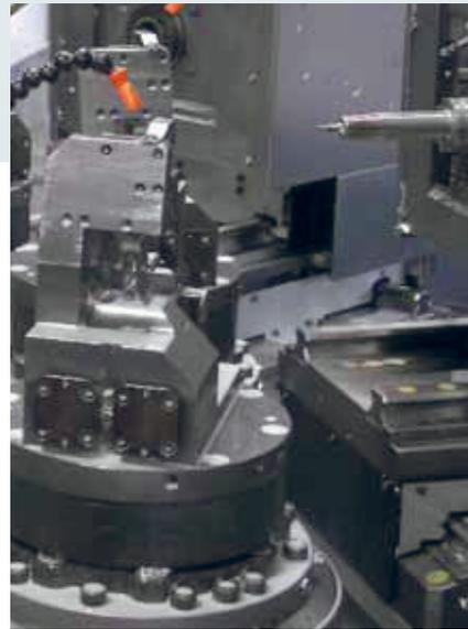
PC 210 als ideales Spannsystem auf Rundtaktmaschinen.
