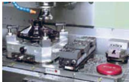
Verschiedene Aufträge auf einer Maschine. Express-Aufträge können problemlos eingeschoben werden. Das Umrüsten der Spannmittel erfolgt in wenigen Sekunden.
