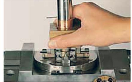
Das Werkstück wird mit der Präzision des ITS Spannsystems aufgespannt. Die Repeitiergenauigkeit liegt bei 0,002 mm.
