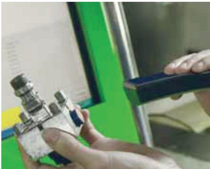
An den Rüst- und Messplätzen werden Handlesegeräte eingesetzt. (Die EWIS™ Rapid Ausrüstung wird optional angeboten).
