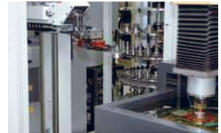
Rand- und Nachtstunden nutzen mit automatischer Beladung der EDM-Maschine: ITS schafft die Voraussetzung dazu.
