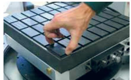
Dank Mediumdurchführung zwischen Spannfutter und Palette lassen sich Werkstücke pneumatisch, hydraulisch oder mit Vakuum spannen.
