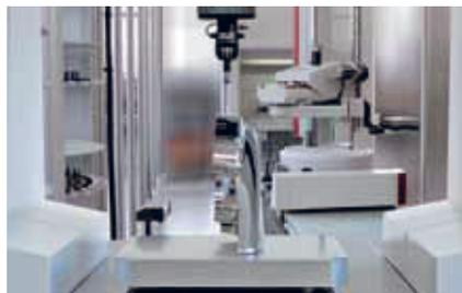
Über das Automationskit (Option) lässt sich die CMM Qi mit einem EROWA Roboter beladen. Die CNC-Steuerung ermöglicht automatische Qualitätsmessungen.
