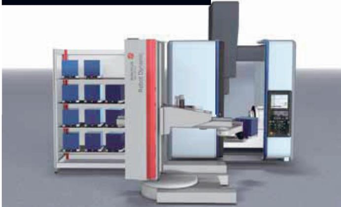
In einer ersten Stufe wird die Maschine so ausgerüstet, dass die Nachtstunden zum grössten Teil genutzt werden können. Dazu reicht ein Magazin aus, bei einer mittleren Bearbeitungsdauer von 30 Minuten pro Werkstück werden so 5 Stunden produktiv genutzt.
