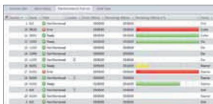
Übersichtliche Darstellung der Werkzeuge an der Maschine inkl. Zustand, Standzeit und Werkzeugbruch.
