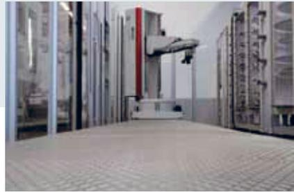
**02** | Die stabile Linearbahn wird in Segmenten auf die passende Länge ausgebaut.
