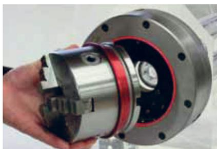
Ein Dreibackenfutter wird eingesetzt. Sowohl Plan- wie auch Rundlauf werden auf 0.002 mm genau repetiert.
