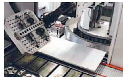
Die Spannfutter sind gegen das Eindringen von Kühlmittel und Spänen vollständig abgedichtet. Die Auflageflächen werden mit Luft automatisch und sauber gereinigt.
