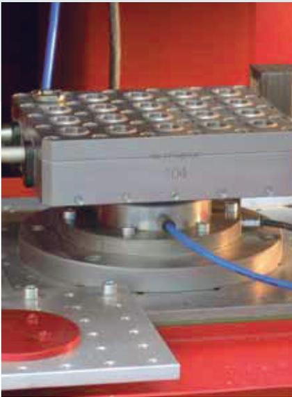
Aufspannvorrichtung mit gerüsteten Werkstücken.
