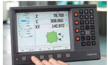
Die praktische Bedienung im EROWA Modus zeigt Schritt für Schritt auf, wie die Versatzwerte ermittelt werden.
