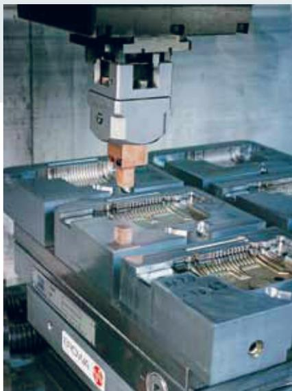
Auf einer Aufspannfläche von bis zu 500 x 500 mm lassen sich auch grosse Werkstücke oder Vorrichtungen problemlos auf der UPC Palette befestigen.
