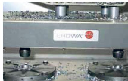
MTS Spannfutter, automatisierbar. Beim Werkstückwechsel werden die Auflageflächen der MTS Palette automatisch gereinigt.
