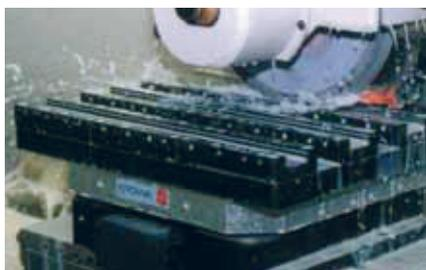
Das UPC Spannfutter auf dem Maschinentisch bildet die Schnittstelle zum Werkstückträger. Mit wenigen Handgriffen wird umgerüstet und weiterproduziert.
