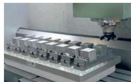
Kurze Rüstzeiten mit flexiblen Spannmitteln: EROWA ClampSet Schraubstöcke auf UPC Rasterpalette.
