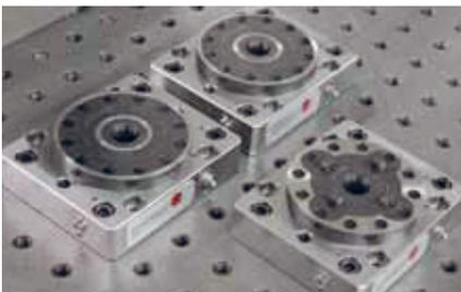
MTS 1-fach Basisplatten sind schnell montiert und einsatzbereit. Passend auf Maschinentische mit Lochraster R50 und T-Nutenabstand 63 mm und 100 mm.
