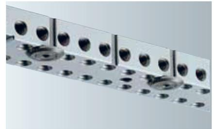
Demontierbare Auflagen dort einsetzen wo sie sinnvoll sind. Erodierdraht durch die spezielle Freistellung einfädeln.
