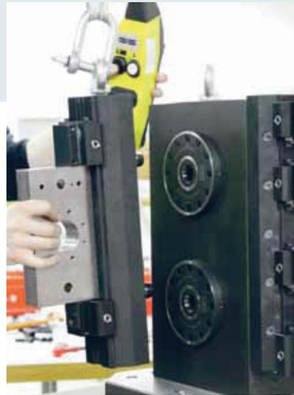
MTS Spannfutter integriert im Mineralgussturm. In Kombination mit EROWA CleverClamp Werkstück-Spannsystem ein entscheidender Produktionsfaktor.
