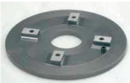
Die flache Präzisionspalette ist die Basis für alle Aufspannungen.
