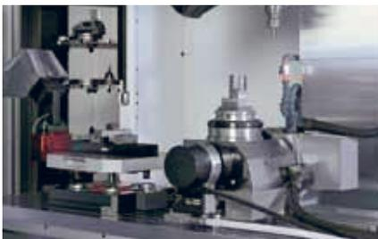
Flexible und automatische Bestückung der Maschine durch ein EROWA Handlinggerät. Der Anteil produktiver Stunden wird wesentlich gesteigert.
