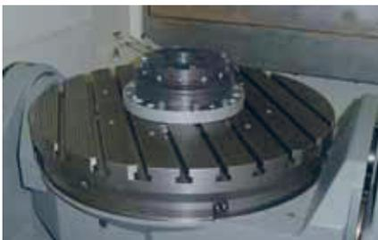
Die vorhandenen Befestigungsbohrungen erlauben einen schnellen Aufbau auf allen gängigen Maschinentischen.
