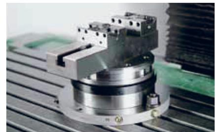
ClampSet Schraubstock auf ITS Palette. In Sekunden  $\mu$ -genau positioniert und einsatzbereit.
