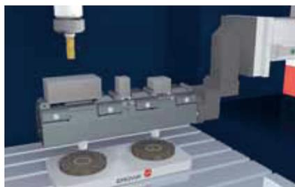
Die CleverClamp Schiene ist direkt automatisierbar. Der Roboter platziert den Werkstückträger präzise und schnell auf der Maschine.
