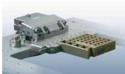
In allen Achsen justierbar: der Pendelhalter mit montiertem Flachsraubstock.
