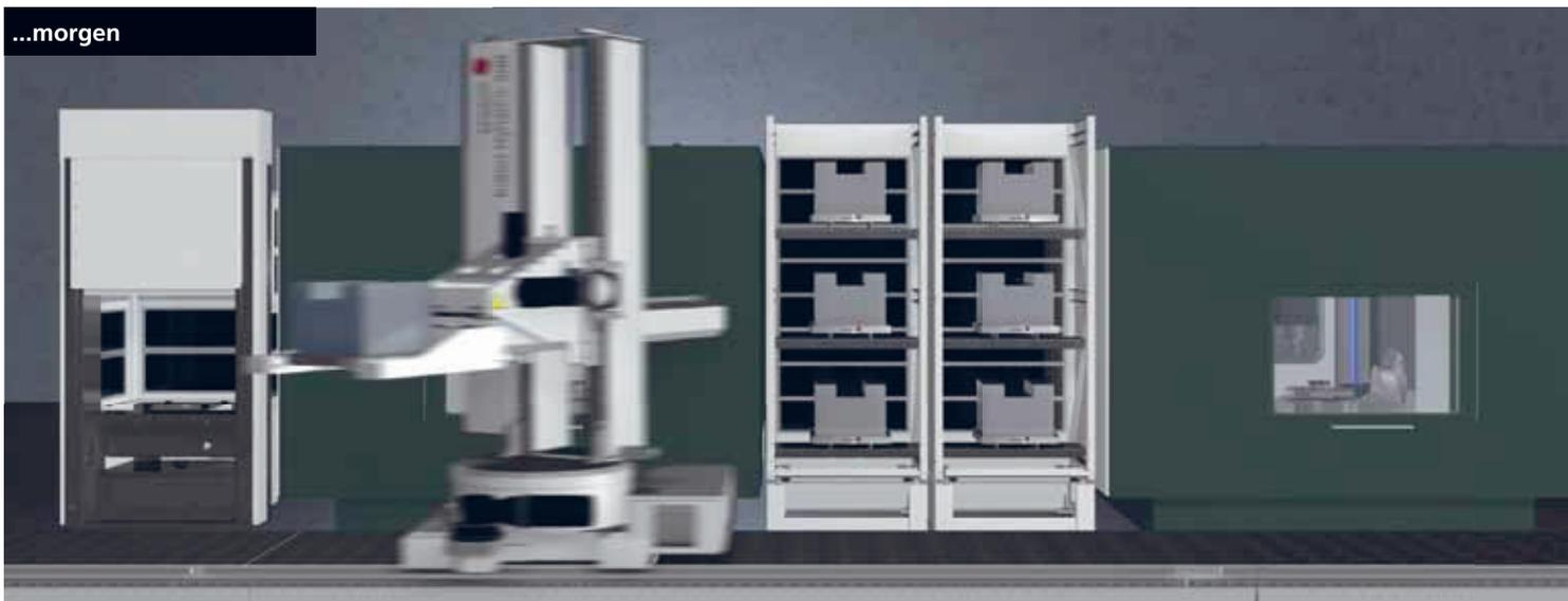
**Nach Bedarf erweitern** - Es werden weitere Maschinen integriert. Der Roboter wird mit einer Schiene und weiteren Werkstückmagazinen ausgerüstet. Die Anfangsinvestition wird weiter genutzt und ergänzt. Die Kapazität der Produktionsanlage vervielfacht sich, weitere unbemannte Schichten können realisiert werden.
