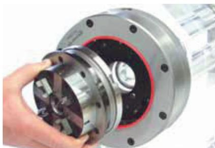
Das palettierte EROWA ITS Spannfutter wird eingesetzt. Durch die Kontur der Palette wird die Spindel völlig abgedichtet.
