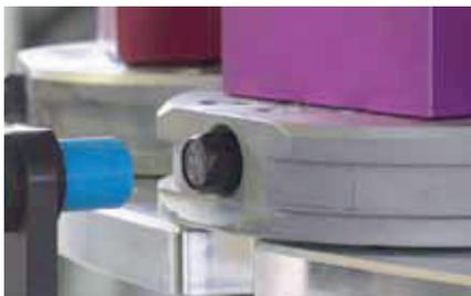
Durch die automatische Paletten-Erkennung über Chip ist jederzeit ersichtlich, welches Teil wo in der Fertigungskette steht. Statusmeldungen werden dem Operator auch über SMS gesendet.
