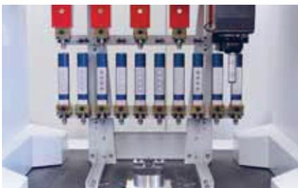
Kapazität: Bis zu 30 ITS 50/72 Elektrodenhalter. Max. Werkstückgewicht 5 kg (inkl. Halter).
