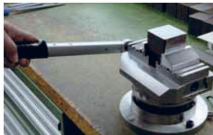
Mit wenigen Handriffs ist das Werkstück im Zentrierspanner positioniert.
