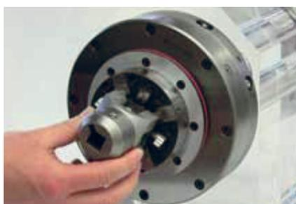
Jegliche EROWA ITS Systemträger werden sicher, schnell und präzis gespannt.
