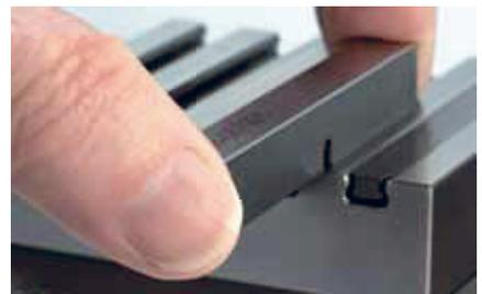
Einfach ist schnell - Spannbacken wechseln im Handumdrehen und ganz ohne Werkzeug.
