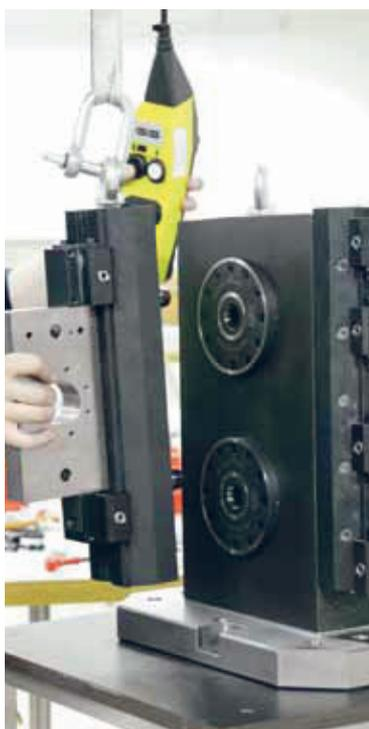
Die CleverClamp Basis-Schienen besitzen beidseitig Bohrungen zum Anbringen von Ringschrauben.
