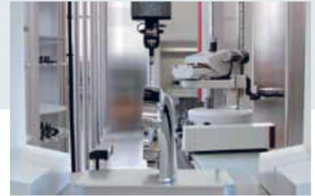
**03** | Das Handlingerät bestückt die Messmaschine mit gefertigten Produkten für die Zwischen- oder Endkontrolle.
