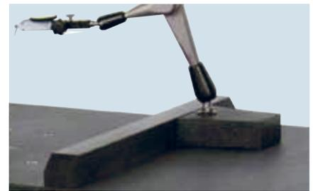
Mit der Messuhr am flexiblen Ständer richten Sie Werkstücke in der Z-Fläche oder der Y-Achse entlang dem Anschlaglineal aus.
