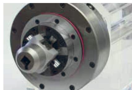
Der ITS 4-Kanthalter dient beispielsweise als Schnellwechsellvorrichtung für kleine Werkstücke oder Elektrodenrohlinge.
