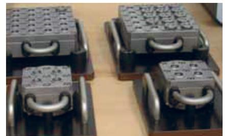
Das Rüsten ausserhalb der Maschine ist ein wesentlicher Erfolgsfaktor für die erhöhte Produktivität der Maschine.
