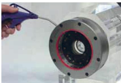
Das auf die Maschinenspindel integrierte Spannfutter wird mit Pressluft geöffnet. Wahlweise über eine Luftpistole, oder über eine fest installierte Luftzuführung.
