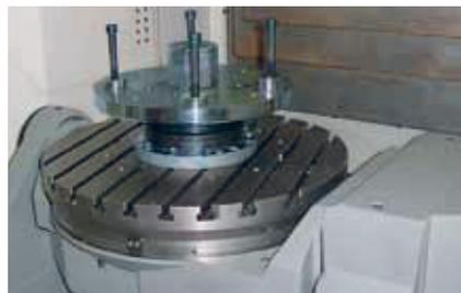
Ein weiterer Vorteil: Montage des Werkstückes oder der Spannvorrichtung direkt auf der PC Palette 210.
