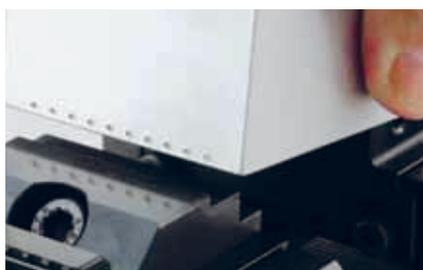
Spannen von Werkstücken mit Präge-technik auf Minimalspannhöhe 3 mm.
