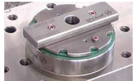
Alle Achsen, X,Y,Z und das Zentrum werden mit derselben Ausrichtpalette geprüft.
