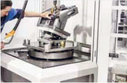
**01** | Um das Rüsten und Vorbereiten von schweren Teilen zu vereinfachen, steht eine Beladestation zur Verfügung.
