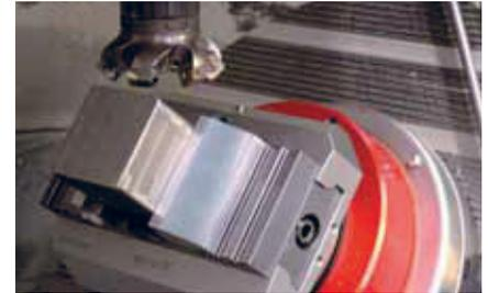
Der Zentrierspanner 148 wird aus rostbeständigem Material hergestellt. Alle Komponenten sind gehärtet. Die hochbeanspruchten Teile sind speziell oberflächenbeschichtet für eine erhöhte Lebensdauer.
