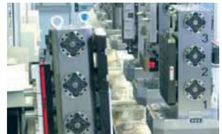
Variabel eingesetzte Spanntürme. Das MTS System bildet die Schnittstelle zu Vorrichtungen und Schraubstöcken. Im Handumdrehen wird umgerüstet.
