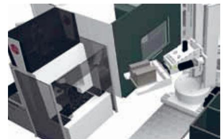
**03** | Integrierte Qualitätskontrolle. Mit der Einbindung einer CMM Qi Messmaschine von EROWA in die Prozesslinie wird auch dieser Anforderung Rechnung getragen.
