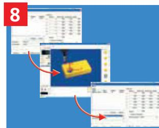
**08** | PreSoft ist nahtlos in JMS® Pro integriert. Die Voreinstellfunktion wird per Mausklick aufgerufen. Die ermittelten Versatzdaten werden vom Messplatz automatisch ins JMS® Pro übertragen.
