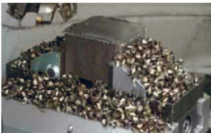
Auch für schwere Zerspangung geeignet: Der Zentrumspanner 148 hält die Werkstücke mit 19'000 N in Position. Durch die Auswahl der passenden Spannbacken wird zusätzlich Stabilität gewonnen.
