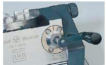
ITS Schnellspannfutter 360° drehbar, Teilungsnonius 5 Minuten (0.08°).
