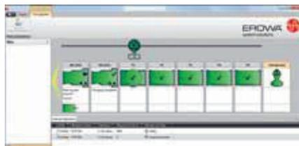
So viel Arbeitsvorrat ist noch verfügbar. Mit jeder Beladung wird berechnet, wie lange die Fräszelle noch produzieren wird.
