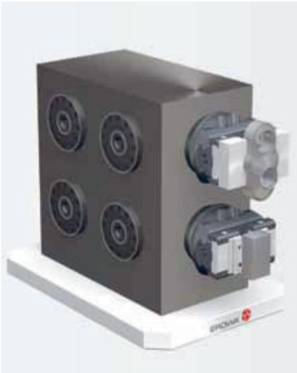
Die Umrüstzeiten werden eliminiert: Vorbereitet werden die Werkstücke ganz bequem auf dem Rüstplatz ausserhalb der Maschine. Zur Bearbeitung werden sie im MTS Nullpunktspannsystem gespannt.
