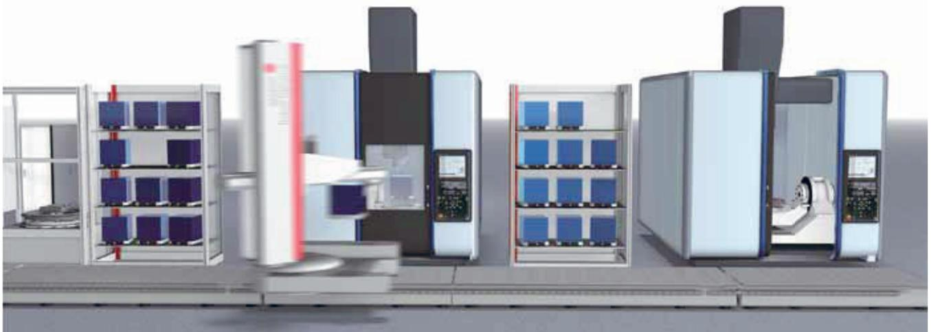
Die Produktionszelle wird erweitert. Weitere Maschinen werden integriert. Der Roboter wird mit einer Schiene, weiteren Magazinen und einer Beladestation ausgerüstet. Die Anfangsinvestition wird weiter genutzt und ergänzt, die Fertigungszelle verfügt jetzt über mehrfache Kapazität.
