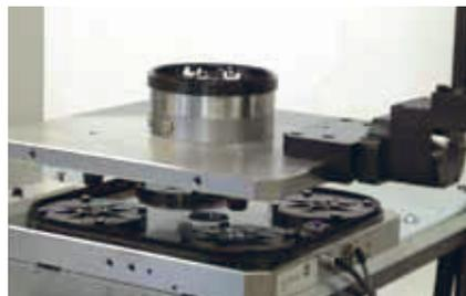
Durchgängige Kombination von EROWA Spannsystemen mit automatischem Handling.
