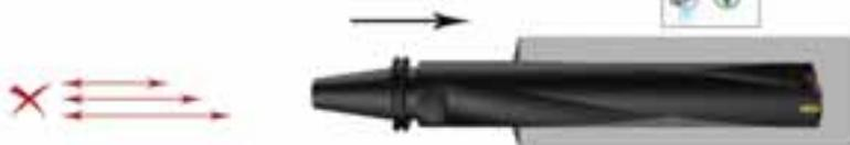
Bohrung mit in den Allied Geschwindigkeits- und Vorschubgeschwindigkeitstabellen empfohlenen Geschwindigkeiten auf ganze Tiefe bohren.
