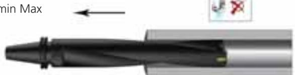
Geschwindigkeit auf maximale 50 U/min reduzieren, bevor der Bohrer zurückgezogen wird
