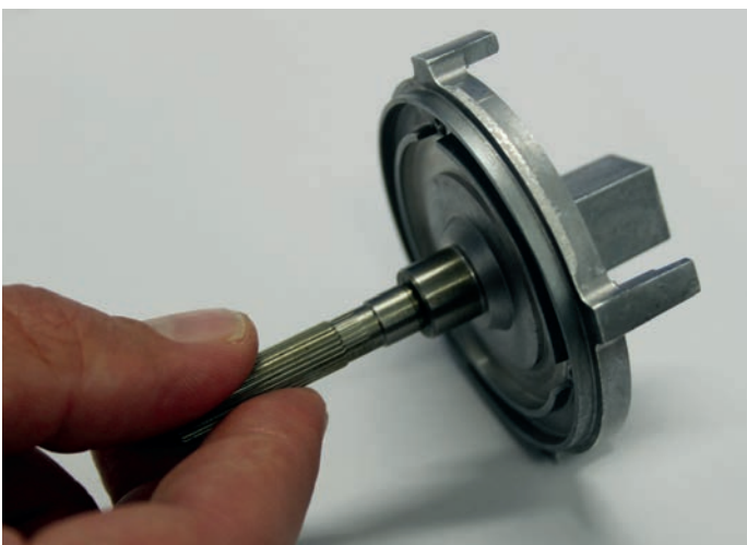
Wellenbaugruppe für ein Kaffeemahlwerk, bestehend aus einer präzisionsgedrehten Stahlwelle und der gefügten Mahlwerkplatte aus Druckguss.
