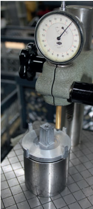
Messtation zur Stichprüfung des Planlaufs nach der Dreh-Endbearbeitung; die reproduzierbare Bearbeitungsgenauigkeit von deutlich unter der max. Toleranz ( 5\ \mu ) wird vor allem auch durch die Doppelspannung in den massiven Präzisions-Spannzangen von Schlenker sichergestellt.
