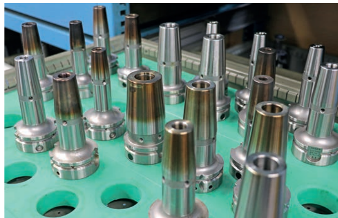
Ob extraschlank oder verstärkt, ob mit oder ohne Cool Flash – für stabile Prozesse und hohe Präzision nutzt GDELS-Mowag eine grosse Anzahl verschiedenster HAIMER-Schrumpfaufnahmen.
