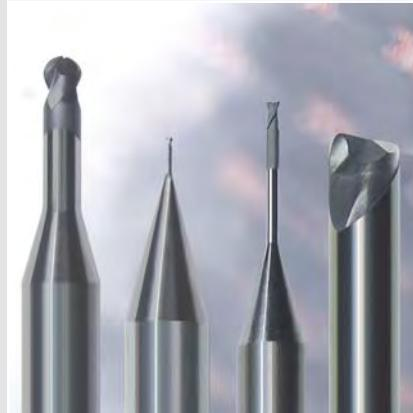
Der entscheidende Unterschied zu den bereits bestehenden High-End- und Qualitätsserien von Zecha ist die effektive Schneidlänge. Die patentierte kürzere Schneide der SEAGULL® Fräser ermöglicht im speziell entwickelten Zusammenspiel von Hartmetall, Beschichtung und Geometrie ein schneiddruckoptimiertes Fräsen von Graphit und anderen hartspröden Werkstoffen. Insbesondere bei der Bearbeitung von Freiformflächen und Rippengeometrien spielt diese Werkzeuggeneration ihre Trümpfe aus.
