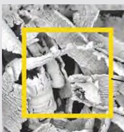
Durch das Fräsen entstandene Späne - Größe ca. 5 bis 8 my Chips caused by milling - size approx. 5 - 8 my
