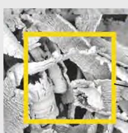
Durch das Fräsen entstandene Späne - Größe ca. 5 bis 8 µm
