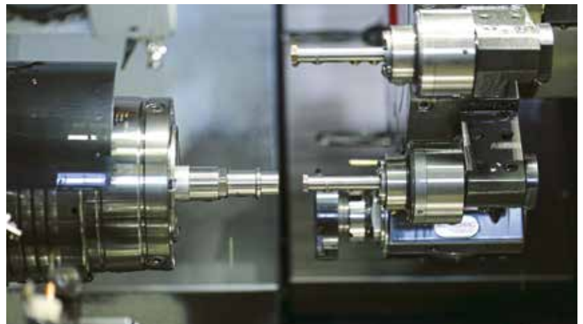
Blick in das Miyano-Drehzentrum. Gut zu sehen: die zwei Reibahlen, gespannt in Pendelfuttern, die für unterschiedliche Durchmesser eingesetzt werden.
