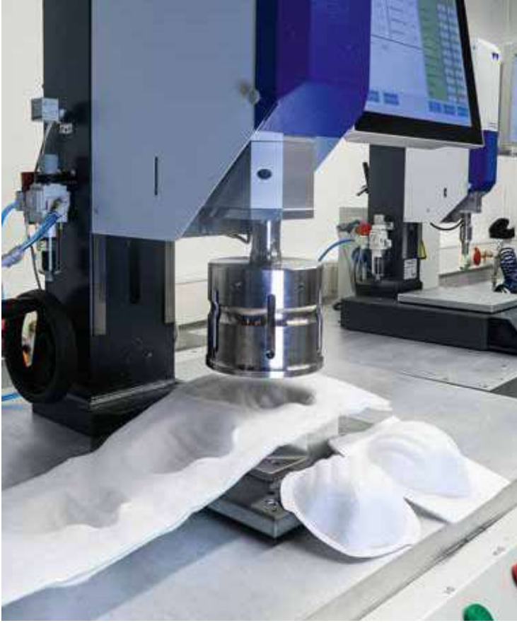
Le soudage par ultrasons de Weber Ultrasonics est utilisé pour la production de masques médicaux.
