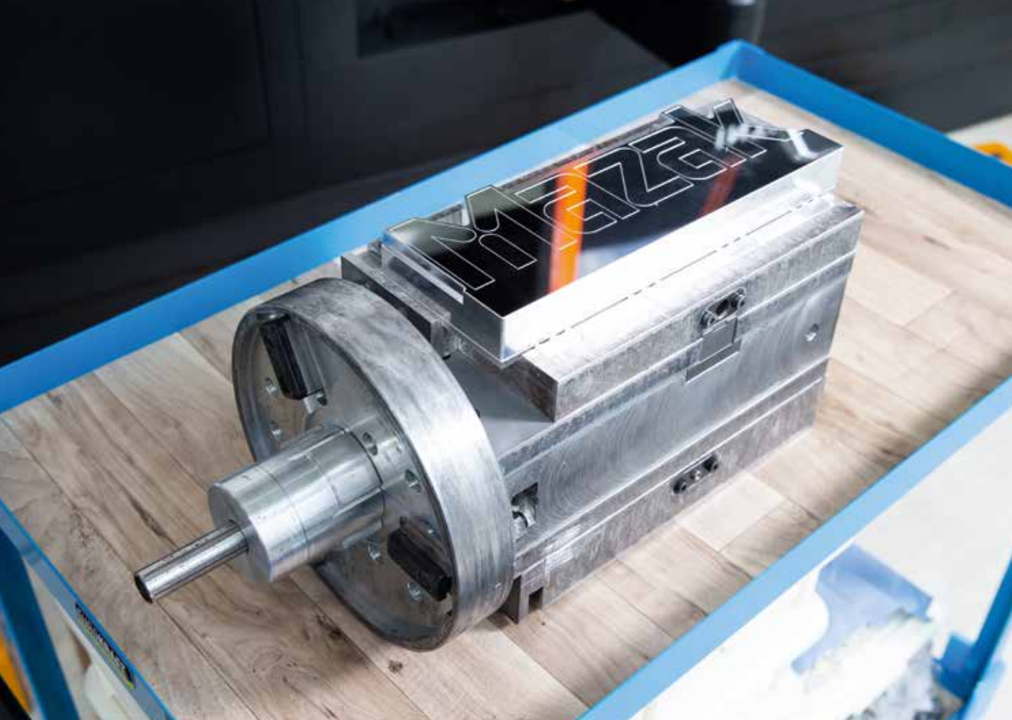
Le dispositif de serrage massif développé par Mazak.
