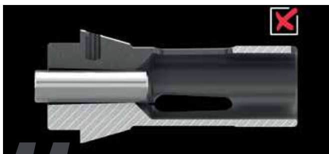
Représentation d'un serrage annulaire ponctuel dans la zone arrière de la surface de serrage."
