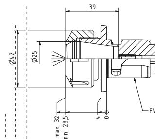
Zweiteilige Lösung „Spannzange“
