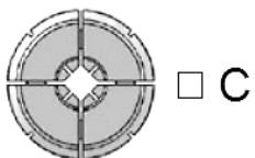
Spannzangen in abgedichteter Ausführung ergänzt um Zusatz: NC
