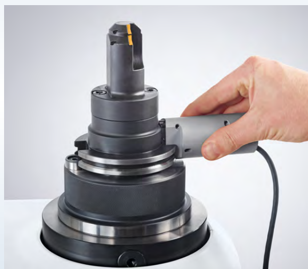
Positionnement manuel de la tête d'écriture/de lecture Posizionamento manuale della testina di scrittura e di lettura
