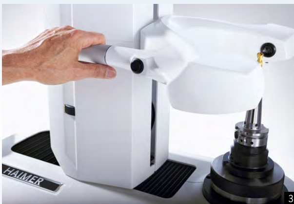
1: Système caméra pour mesure du centre de rotation/ Telecamera per la misurazione del centro di rotazione
