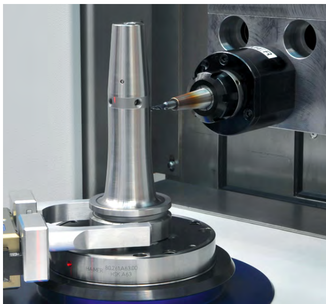
Elimination automatique du balourd grâce à l'unité CNC Eliminazione automatica dello squilibrio per mezzo di una unità CNC
