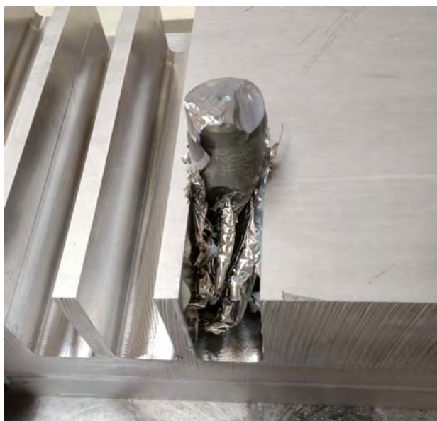
Pas d'extraction de l'outil avec le Safe-Lock Con Safe-Lock non avviene lo sfilamento dell'utensile
