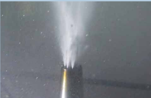
Cool Flash – refroidissement efficace sur les arrêtes de coupe Cool Flash – raffreddamento effettivo fino al tagliente
