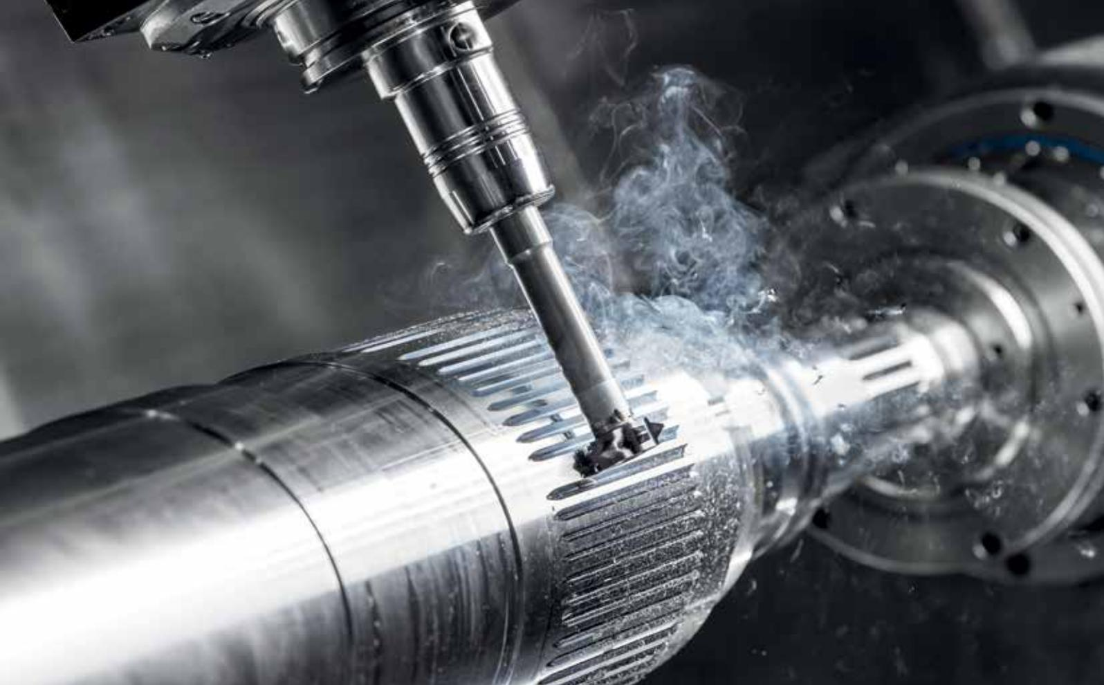
Beschichtungen verfügbar. Der Vollhartmetall-Werkzeugschaft stellt durch seine Masse die Schwingungsdämpfung im Fräsprozess sicher. Alle Varianten der Werkzeugschäfte sind mit einer inneren Kühlmittelzufuhr ausgestattet.
