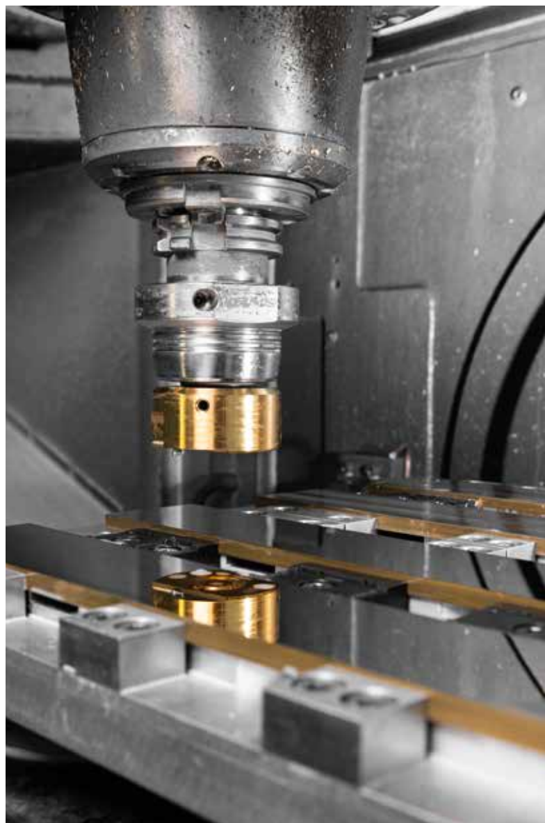
Das Hochglanzfräsen erzeugt perfekte Ebenheiten und spiegelnde Oberflächengüten im Nanometerbereich.
