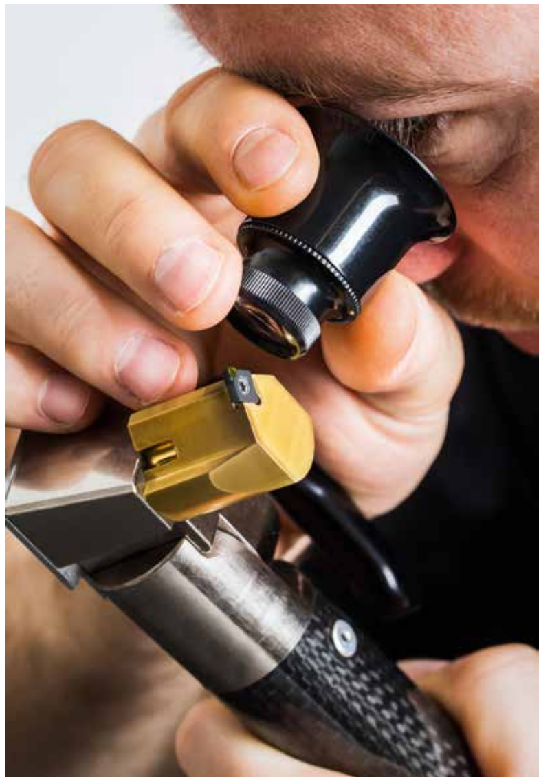
Nachschleifservice: MKD-Schneiden lassen sich mehrmals nachpolieren.
