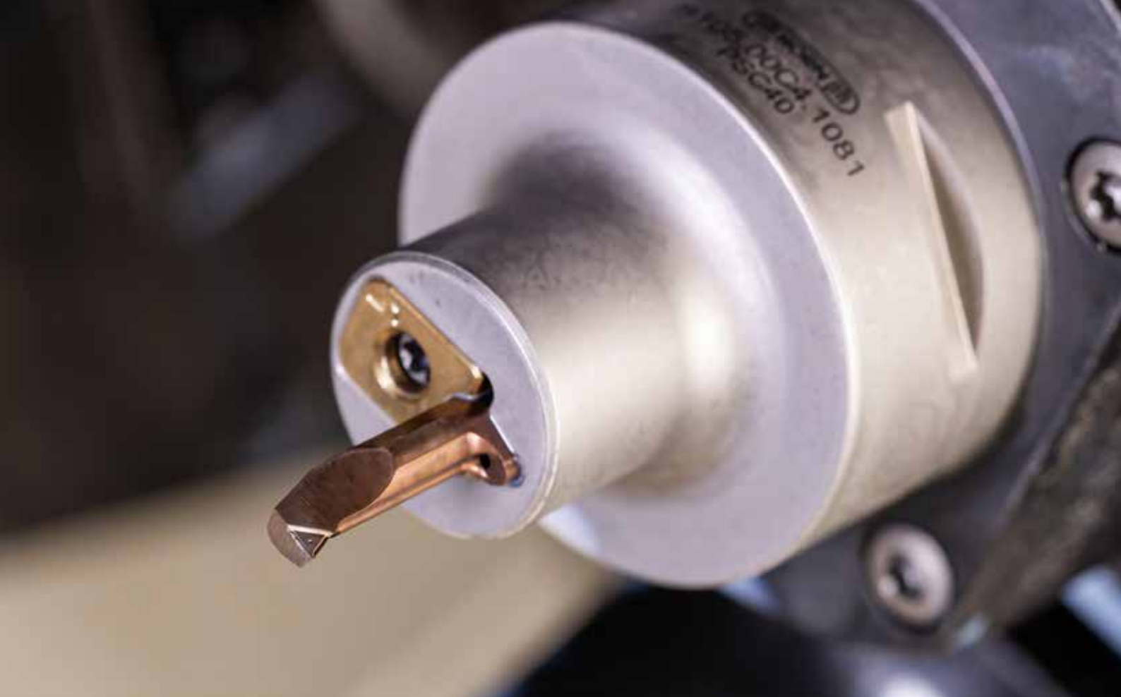
Die neue Supermini-Variante mit gesinterter Geometrie löste die Spanprobleme.
