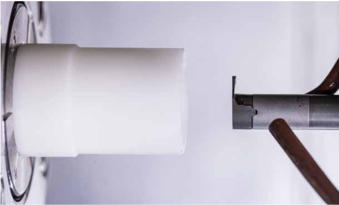
Zum Innenausdrehen kommt das HORN-System des Typs Mini zum Einsatz.
