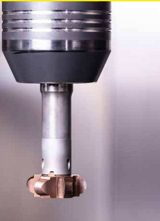
Die Hohlkehlen fräst Götz mit einem Vollradiusfräser.
