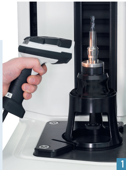
Längenvoreinstellung und Scan des Data-Matrix Codes zur automatischen Identifikation der Schrumpfparameter Length presetting and Scan of Data-Matrix Code for automatic identification of shrinking parameters
