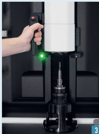
Abkühlung der Schrumpfschraube mit Temperaturkontrolle Cooling of shrink fit collet with temperature control
