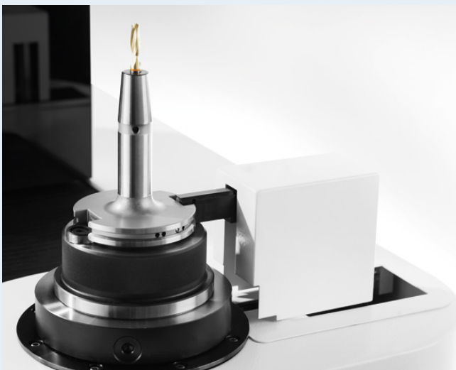
Automatische Positionierung des Schreib-/Lesekopfes Automatic positioning of the read/write head
