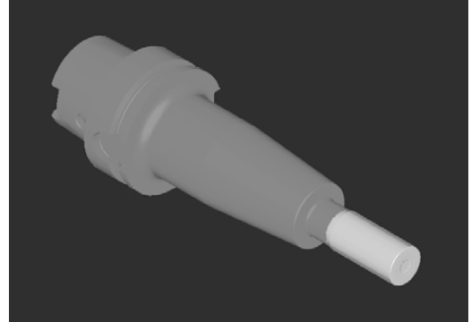
3D-Modell mit einfacher optischer Unterscheidung cut/no-cut 3D model with simple visual differentiation cut/no-cut
