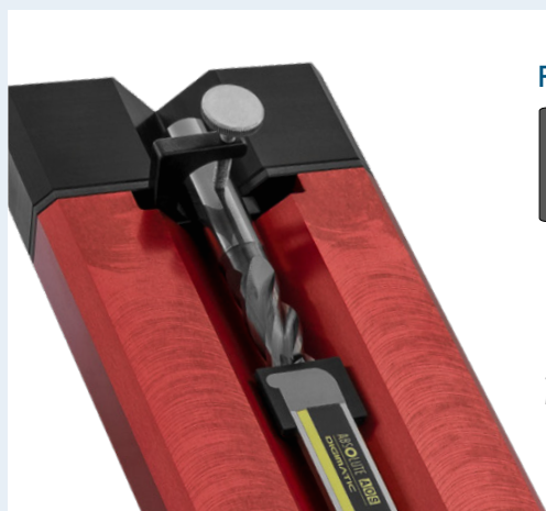
Schrumpffutter erwärmen. Heat up shrink fit chuck.
