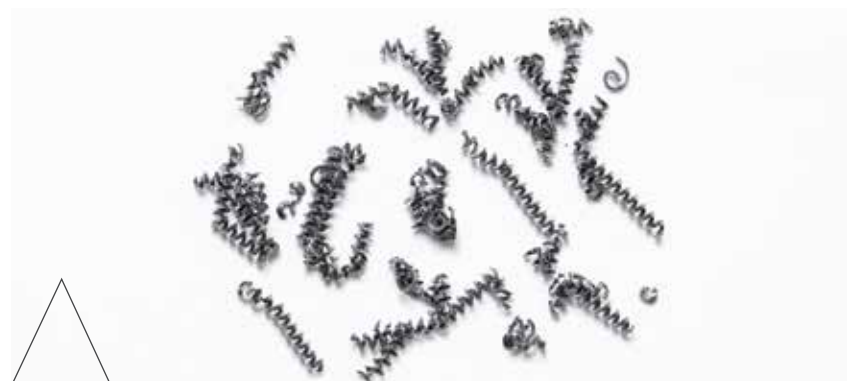
Die gesinterte Spanformgeometrie sorgt für kurze feine Späne.
