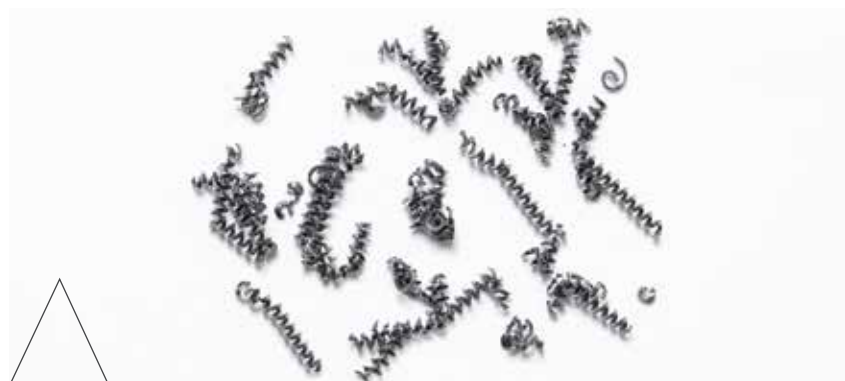
La géométrie de brise-copeaux frittée génère des copeaux courts et fins.
