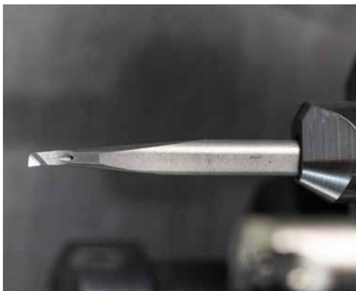
Pour l'alésage intérieur, on utilise le système Supermini équipé de PCD.
