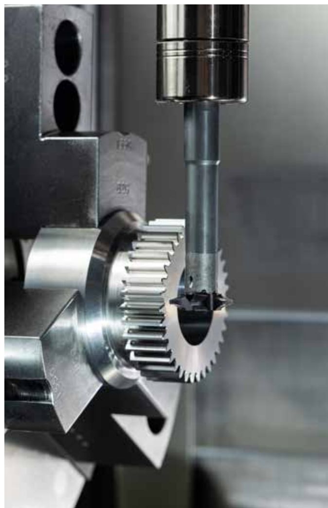
Pour le fraisage des dentures, Rommelag mise sur le système de fraisage circulaire HORN.
