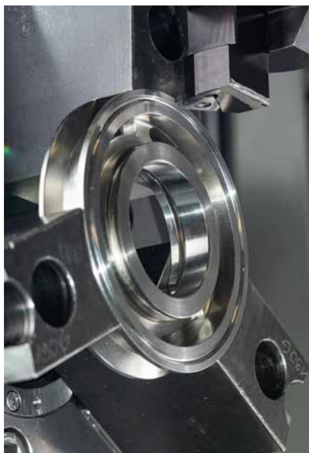
Le tronçonnage axial des gorges pour joints toriques est assuré par le système 315.
