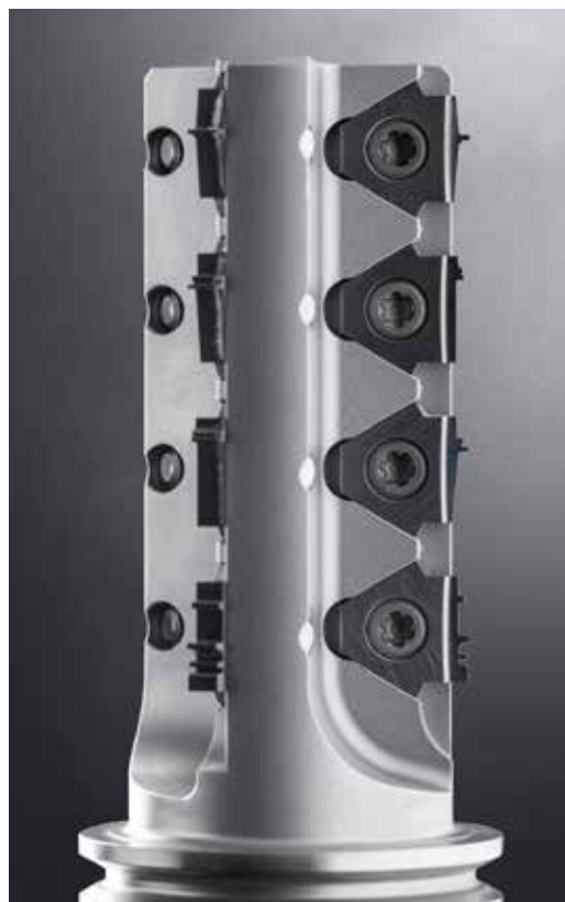
Pour cet outil spécial, HORN utilise la plaquette de coupe S117.
