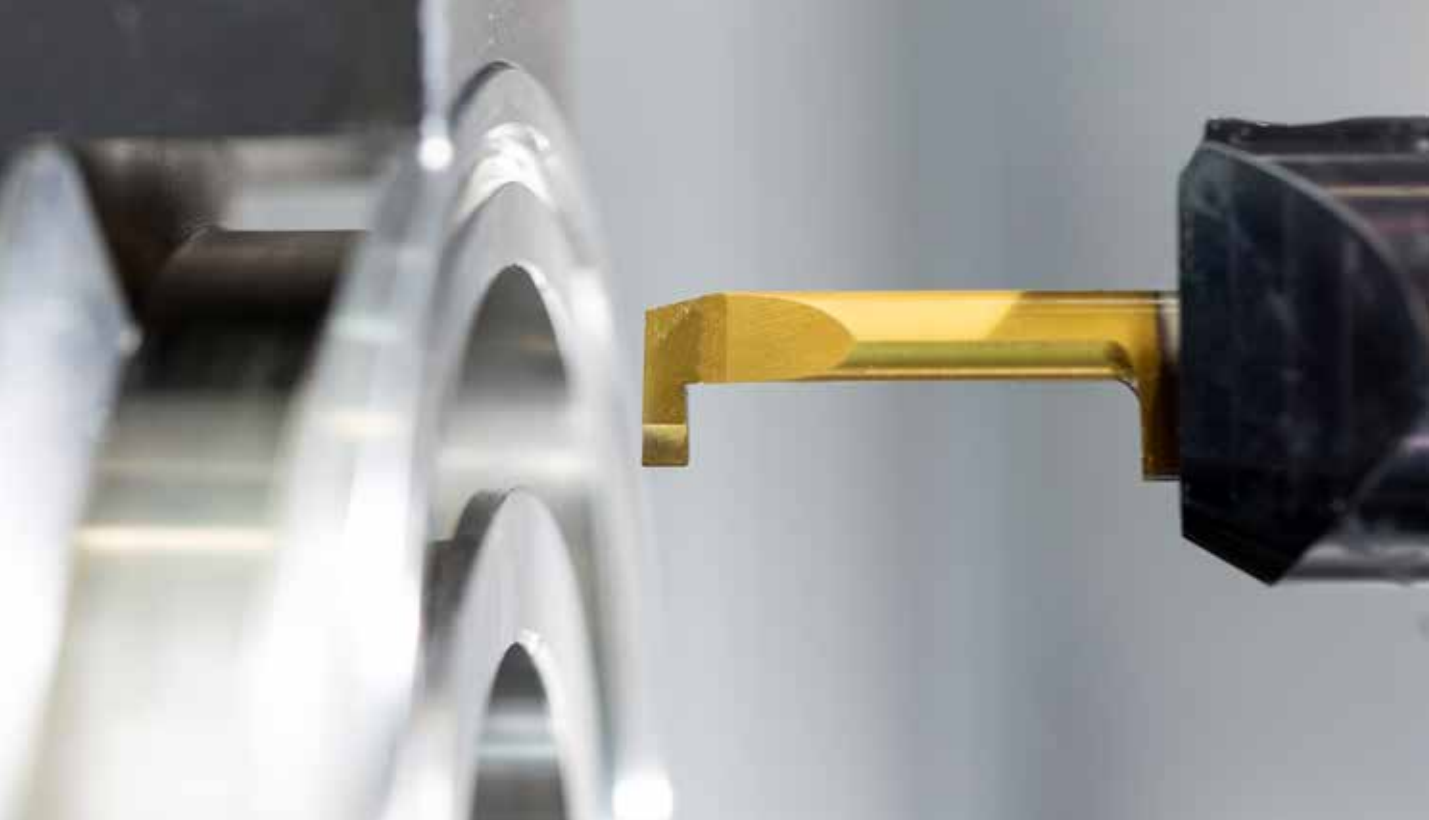
Le système Supermini est utilisé pour les gorges intérieures.
