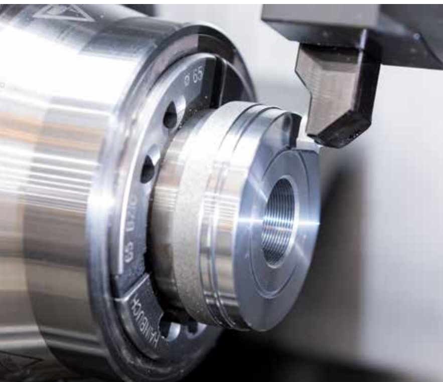
Goujure axiale dans le carbure G30 : un usinage particulièrement exigeant, réalisé avec une grande fiabilité chez Linhardt Tec.Point.
